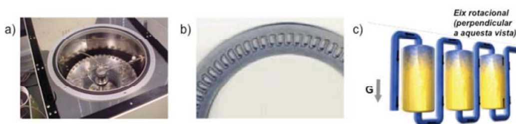
Figura 1.9. Esquema d'un aparell CPC (Sanki, Japó): a) Detall del rotor del dispositiu de CPC. El rotor té un sol eix de rotació perpendicular al rotor; b) Imatge d'un dels discs que constitueixen el rotor; c) Representació esquemàtica dels canals i conductes excavats en aquests discs.
