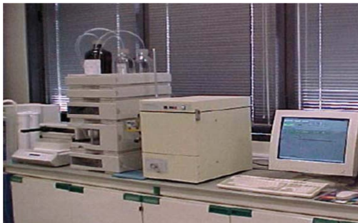
Figura 1.7. Exemple d'un dispositiu de CCC en el que la columna de cromatografia de repartiment centrífug (CPC) està acoblada a un sistema d'HPLC convencional (bomba, injector i detector).
