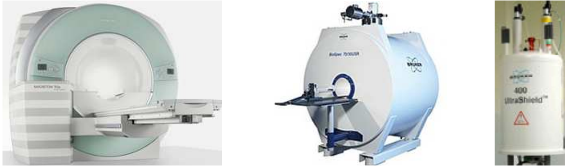
Figura 11.6 Aparells de RM: Siemens per pacients (esquerra), Bruker Biospec per animals petits (centre) i Bruker 9.4T per animals petits i mostres (dreta)
