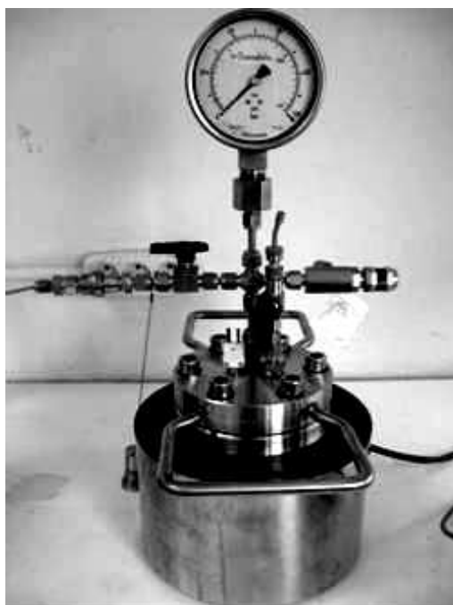
Figura 3.14. Reactor utilizado en los experimentos de sobrepresión con \text{H}_2 gas.
