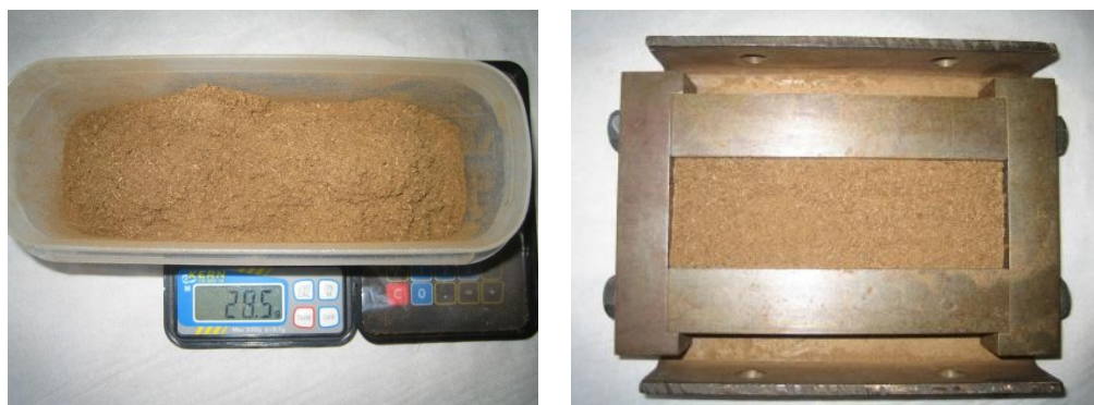
Figura Anejo I-5.1-1: Pesado del material y relleno del molde para prensado en frío
